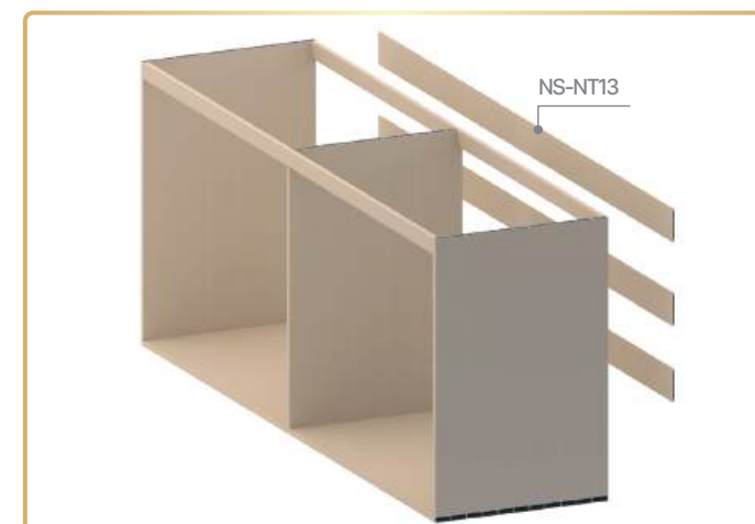
7. Lắp các thanh NS-NT13 liên kết bằng vít
